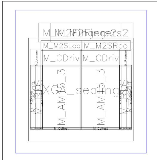
**Figure 6-21 : SXGA module partitioning**
