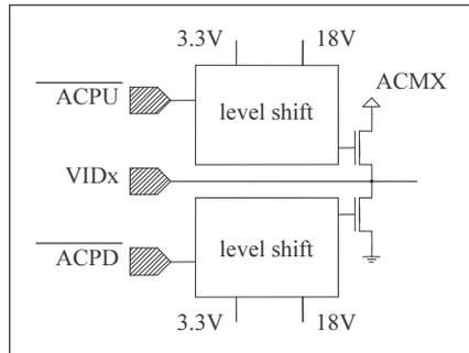
**Figure 6-56 : active clamping circuit**
