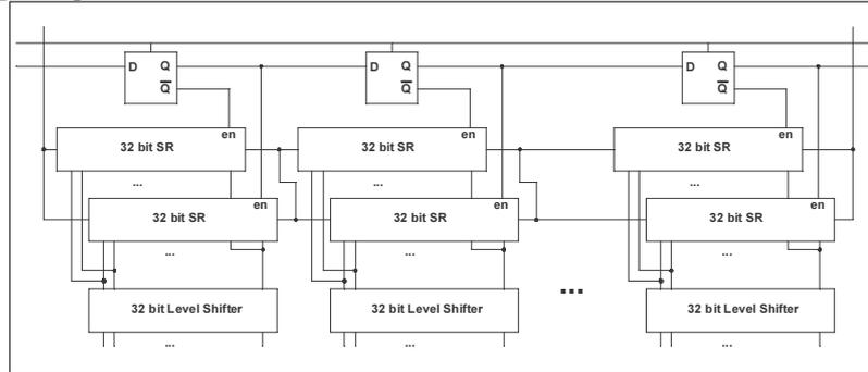
**Figure 6-33 : shift register redundancy**
